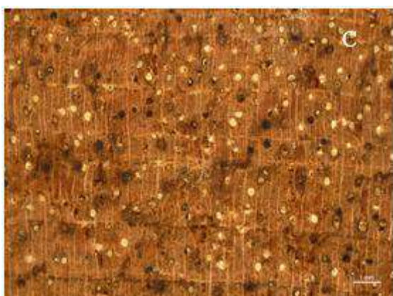
Figura 4. Deterioração observada no alburno da amostra C de Jatobá sob lente de aumento de 20x.
