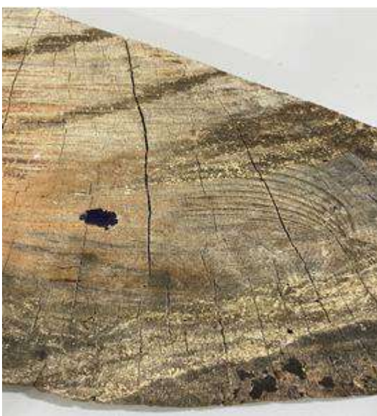
Figura 6. Resultado do teste de Cromoazurol S da amostra do gênero Vochysia.
