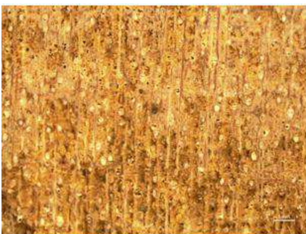
Figura 7. Deterioração observada no alburno da amostra do gênero Vochysia sob lente de aumento de 20x.
